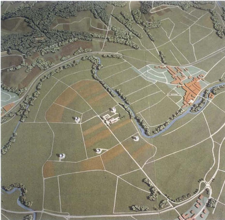
Bild 1 Anordnung der Antennen und des Zentralgebäudes (Modell der Deutschen Bundespost)
